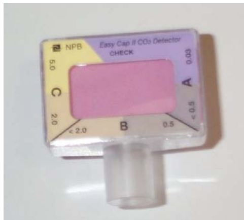
Photographie 7 - Capteur de CO 2 télé-expiratoire de type Easy Cap II
