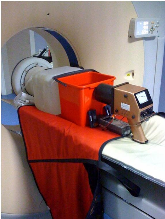
Photo 1 : Montage utilisé montrant le fantôme en plexiglas de 20 cm de diamètre et de 20 cm de longueur sur lequel a été réalisé l'acquisition (120 kVp et 280 mAs, eff). Les mesures ont été réalisées à 20 cm, 40 cm (photo 1\*) et 60 cm de distance au fantôme
